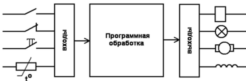
Рис. 1.2.1 – Программируемый логический контроллер
