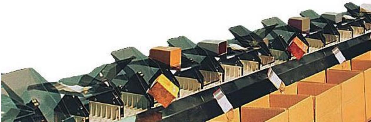
Рис.5 – TiltTray C наклоняющимися лотками
