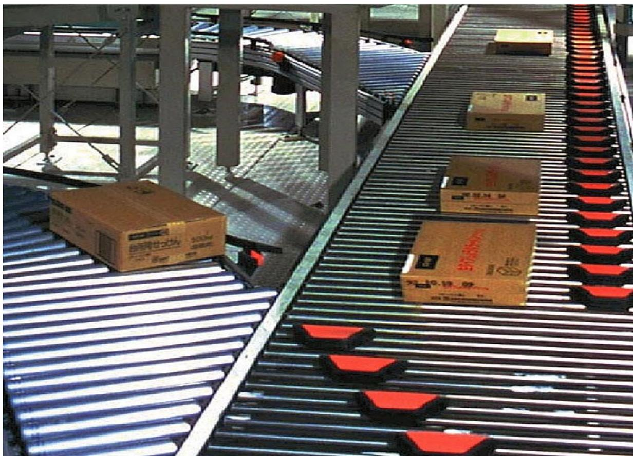
Рис.8 – Сортировочная машина с отклоняющими кулачками
